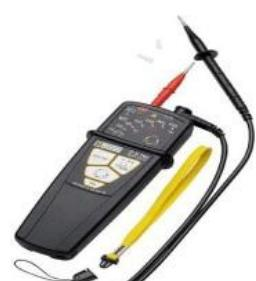
**INTERDICTION d'utiliser un VAT pour mesurer une présence de tension**
